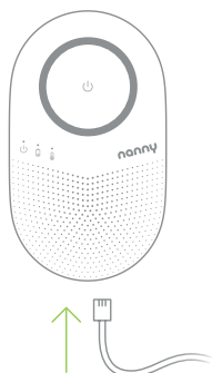
Abb. 9 Anschließen des Anschlusskabels an die Kontrolleinheit
