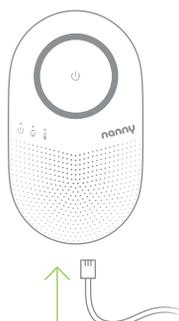
Fig. 9 Connecter le câble à l'unité de contrôle
