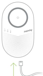
Fig. 9 Collegamento del cavo di collegamento all'unità di controllo
