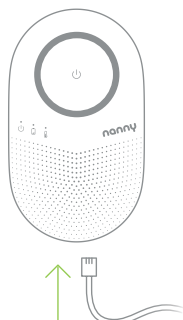
Rys. 9 Podłączanie kabla potężeniowego do jednostki sterującej
