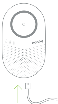
Slika 9 Spajanje priključnog kabela na jedinicu za procjenu
